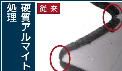
ねじ山の頂点と谷底が薄膜に。腐食・割れの原因に！
